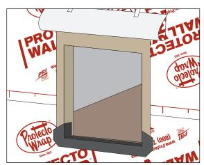
Install Protecto Sill Pan Flash with Protecto Spray Tak Primer.
